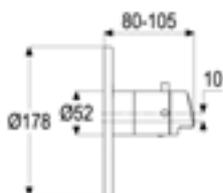
**Z051691-00010****Fertigbauset Brausethermostat**RG 1c
